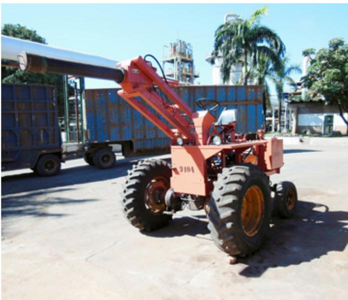
Visando amenizar este problema, a usina Diana adquiriu uma sonda movida a trator. Com este equipamento será possível coletar amostras das carretas antes que elas descarreguem suas cargas nas mesas alimentadoras. Desta maneira, realizaremos análises mais precisas de impureza mineral (terra) e iniciaremos o acompanhamento da impureza vegetal (palha, palmito, raiz etc.).
