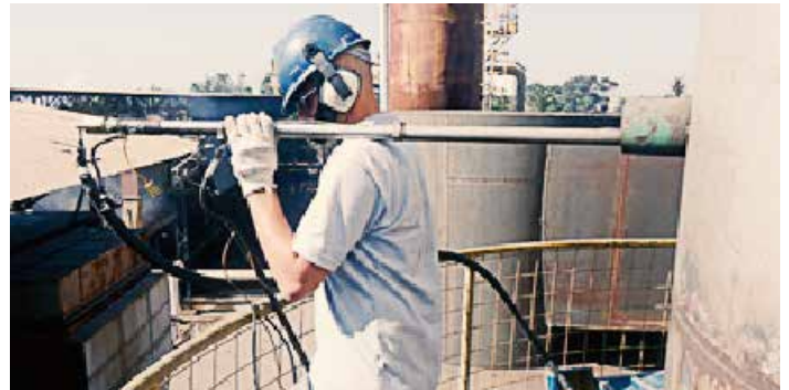
Foto 1: sonda instalada na chaminé para coleta.
