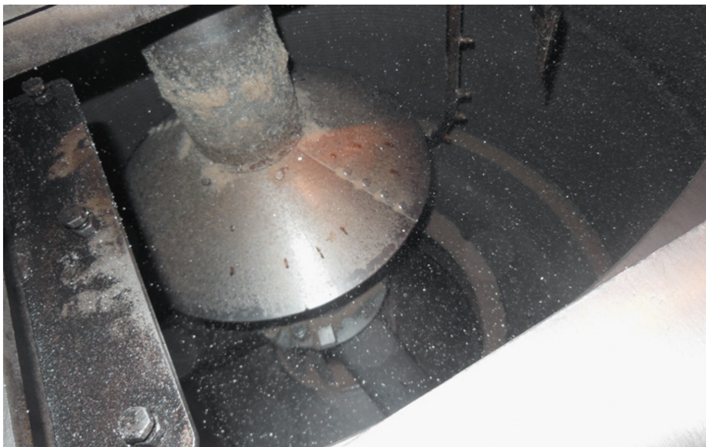
- Tela da centrifuga durante a etapa de descarregamento do açúcar.
