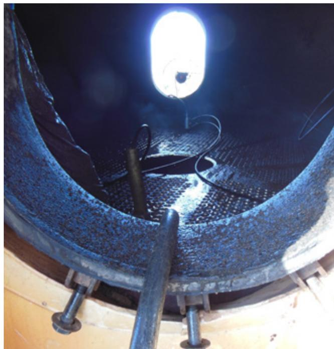
Caixa de evaporação em processo de limpeza
